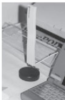
Figura 1.24 - Antenas omnidirecionais. Fonte: Foto extraída do site [www.lucent.com](http://www.lucent.com)
