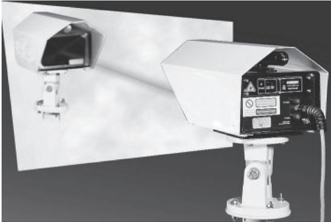
*Figura 1.7 - Enlace ponto a ponto utilizando tecnologia de laser.
